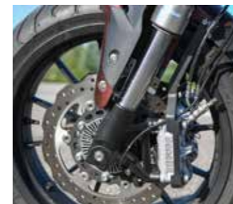
Op de radiale vierzuiger remklauw zit een beugel voor het voorspatbord gemonteerd
