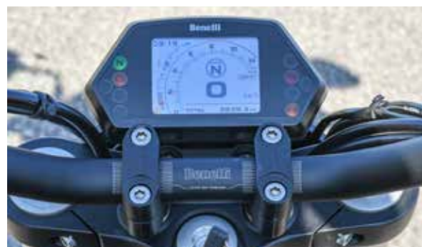
Overzichtelijk TFT-display en in standen verstelbaar stuur
