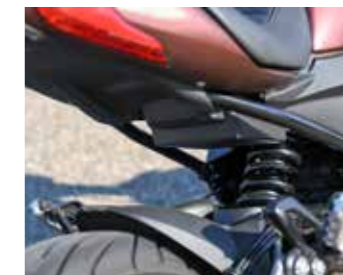
De veervoorspanning van de achterschokdemper is regelbaar, instelbare demping zou een welkome aanvulling zijn
