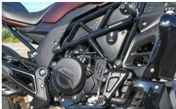
Het buizenframe met het vloeistofgekoelde paralleltwin motorblok met dubbel bovenliggende Nokkenas
