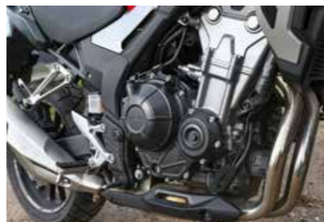
Extreem soepel parallel tweecilinder motorblok
