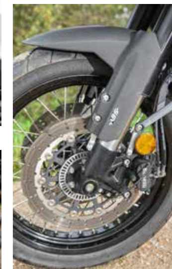
Dubbele 320mm remschijven met tweezuigerklaauw
